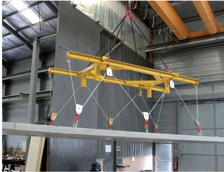
figure 5 – Palonnier soulevant une prédalle
